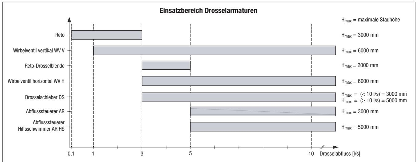
Daneben entscheidet auch die erforderliche Trennschärfe über die Wahl der passenden Drosselarmatur. Als Auswahlhilfe wird der Unschärfefaktor UF eingeführt. Er muss mit dem Drosselabfluss  $Q_{r, \text{krit}}$ , multipliziert werden, um den Bemessungszufluss für die nachfolgenden Anlagen zu erhalten.
