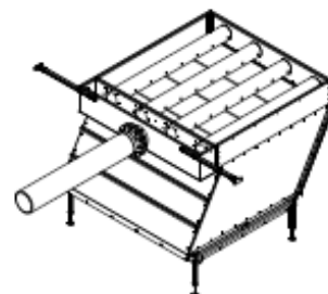
Isometrieansicht Überlaufschwelle / Lamellenaufnahme
